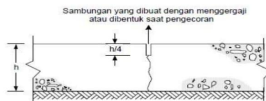
Gambar 2.4 Sambungan Susut Arah Melintang Tanpa Ruji Sumber : Bina Marga, 2002
