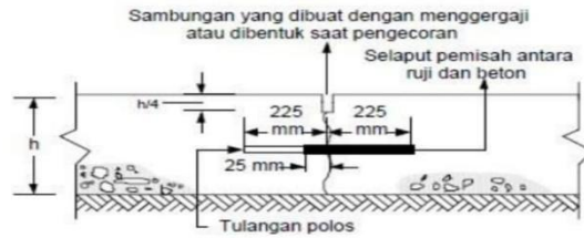
Gambar 2.5 Sambungan Susut Arah Melintang Dengan Ruji Sumber : Bina Marga, 2002
