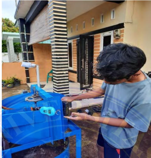
Gambar 3. 14. Proses Pengambilan Data Beban dengan Metode Prony Brake
