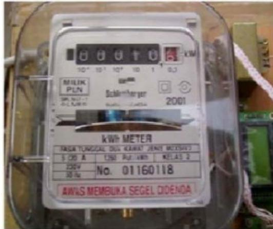
Gambar 2.6. KWH Meter Analog
