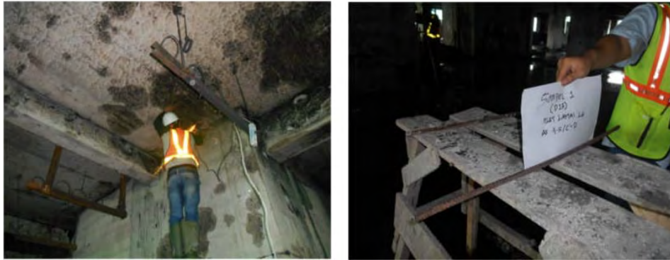
Gambar 3.10 Pengambilan Sampel Tulangan Uji Tarik Sumber: Pihak Pengelola The Reiz Condo Medan
