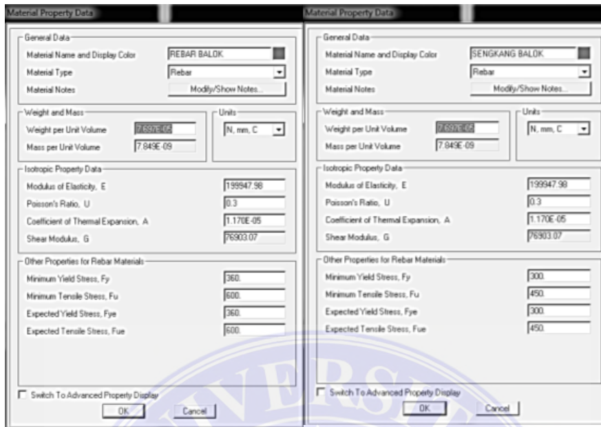
Gambar 2.16 Input Data Tulangan Balok Sumber : Progran SAP 2000
