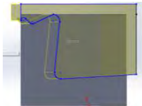
Gambar 3.9. Perintah Extrude Cut Untuk Membuat Bentuk Rahang
