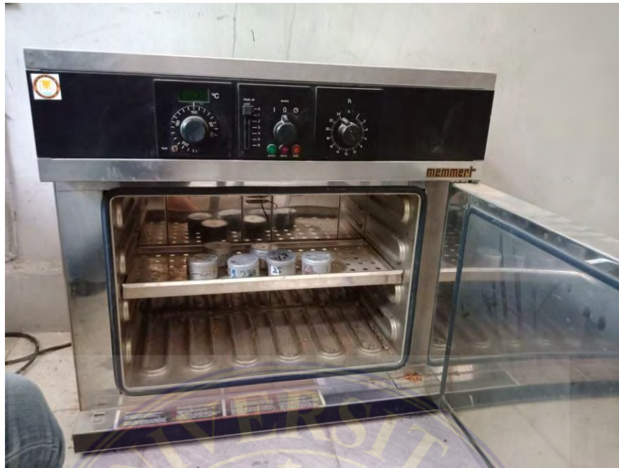
Proses Pengeringan Tanah dengan Oven
