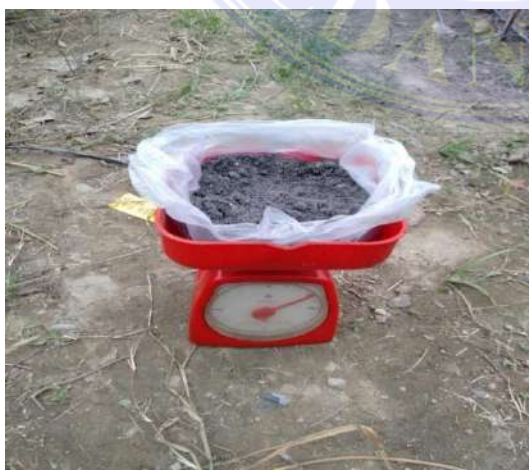
Gambar 5. Penimbangan abu sabut kelapa
