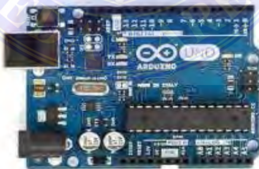
Abbildung 2.2: Physische Form des Arduino Uno (Quelle: Arduino, November 2014, „Arduino Board Uno“)
