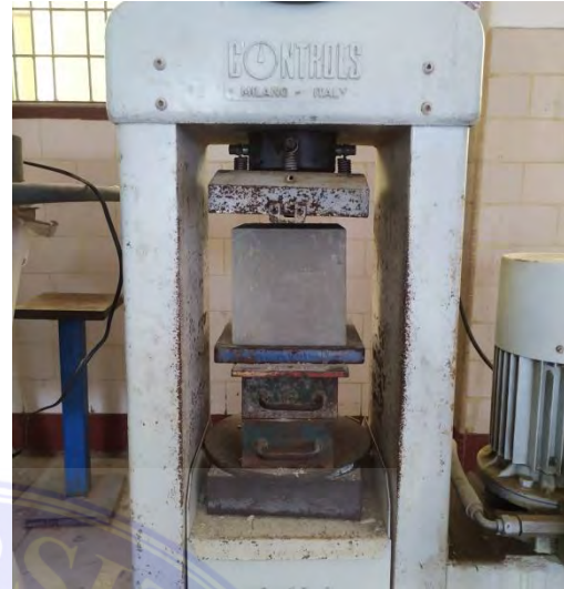
Pengujian kuat tekan beton
