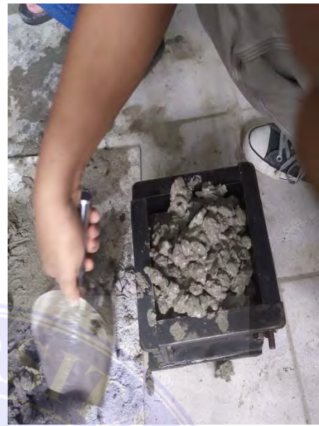
Memasukkan beton segar kedalam cetakan
