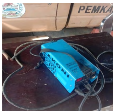
Gambar 4.10 Mesin Las Listrik Sumber : Dokumentasi Lapangan
