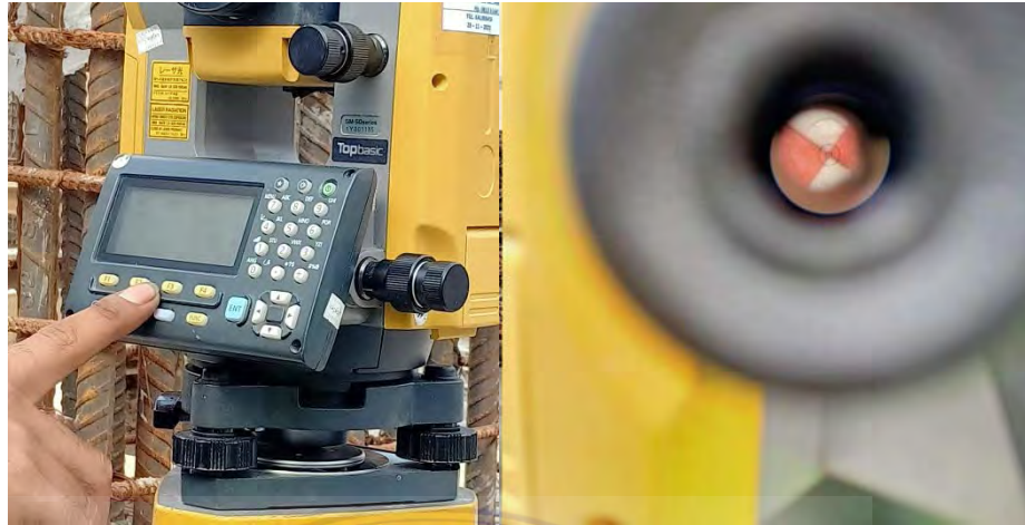
Gambar 3.16 Penggunaan Theodolit Digital Pada Pengukuran Kolom
