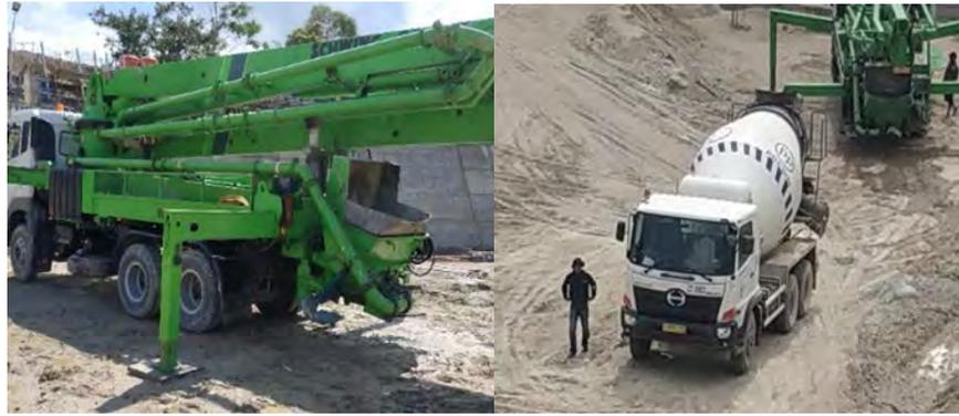
Gambar 4.32 *concrete pump* (kanan) dan *mixer truck* (kiri).
