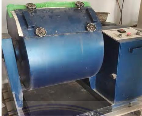
Gambar 3.12 *machine* abrasi batu
