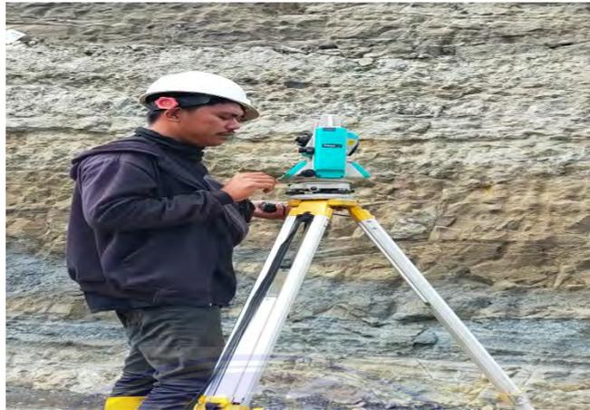
Gambar 3.5 Alat Ukur *Teodolit*
