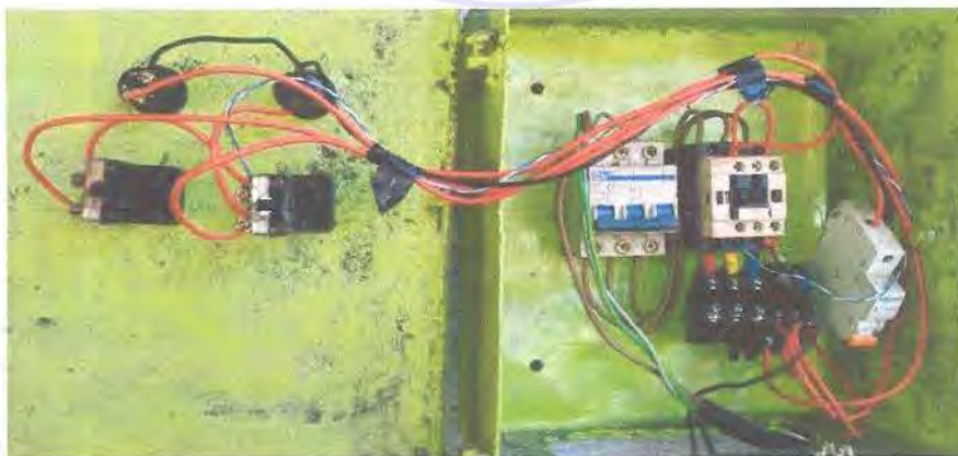
Gambar 3.10: Rangkaian daya da rangkaian kontrol pengasutan DOL (Sumber: dlscrib.com-pdf-laporan-kp-motor-induksi-3-fasa-dl)
