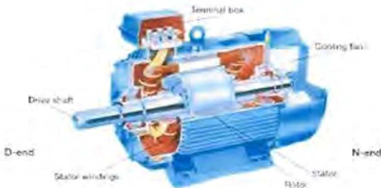
Gambar 2. Komponen Motor Listrik
