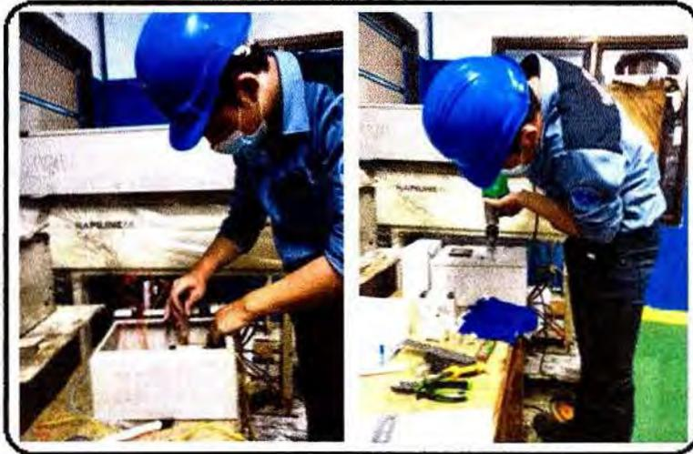
Gambar 16. Proses merangkai rangkaian DOL pada panel kontrol
