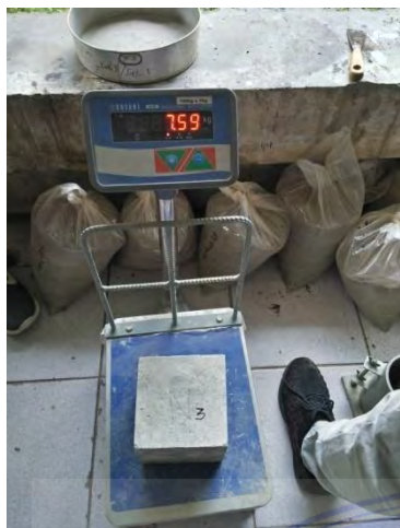
Beton normal ditimbang sebelum diuji
