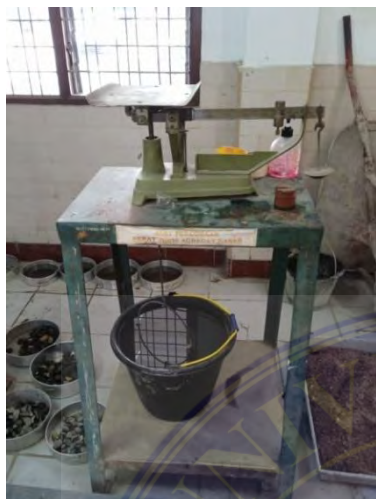
Alat Percobaan Berat Jenis Agregat Kasar
