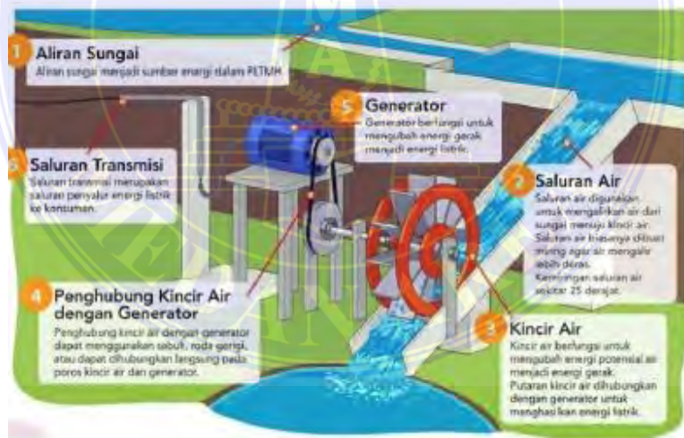
Gambar 2.6. Skema Pembangkit Listrik Tenaga Mikro Hidro
