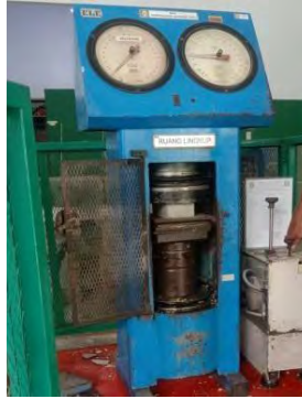
Gambar 2.7 Alat Uji Kuat Tekan Sumber : Laboratorium Teknologi Bahan Konstruksi Universitas Sumatera Utara
