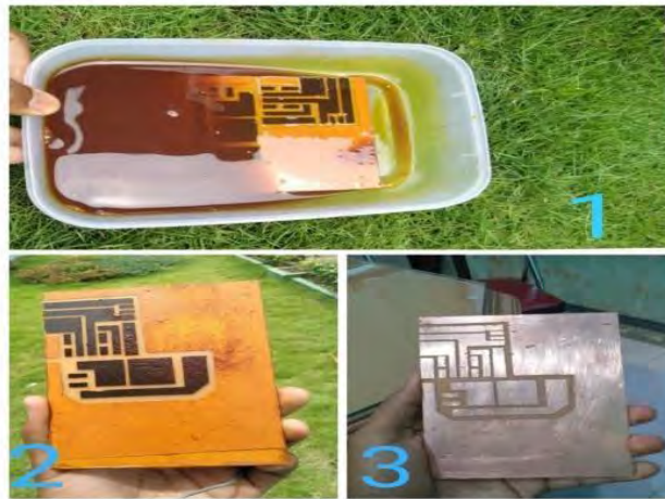
Gambar 3.1 : Proses pembuatan papan PCB
