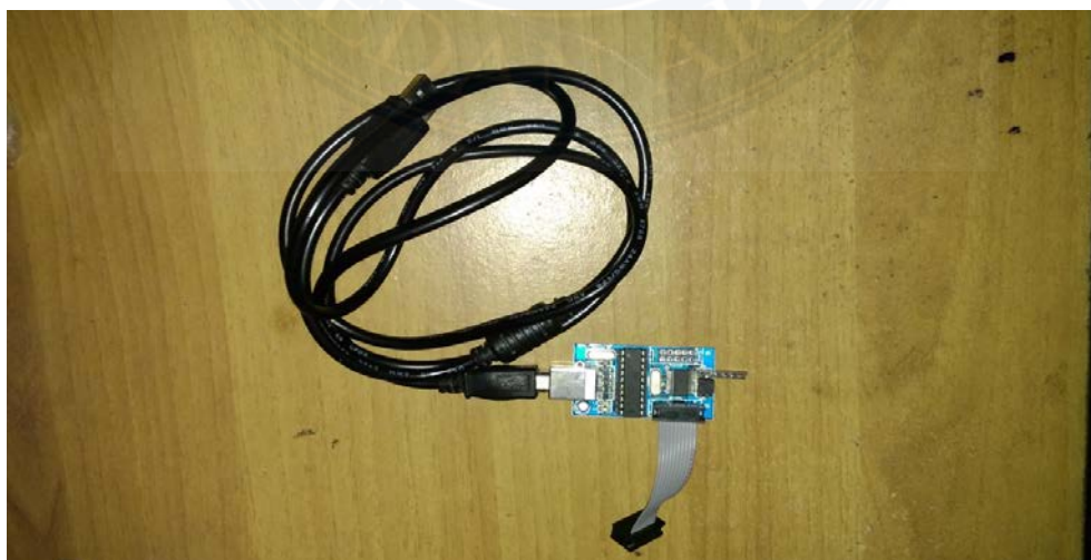
Gambar 3.10 USB ISP AVR (USB AVR910 Downloader)
