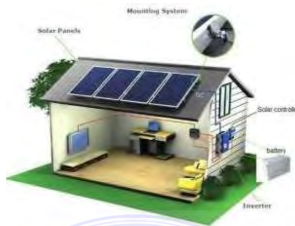
Gambar 2.13 : Konfigurasi PLTS solar home system
