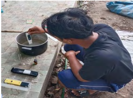
Pengukuran Konsentrasi Hormon IAA Menggunakan TDS EC Meter
