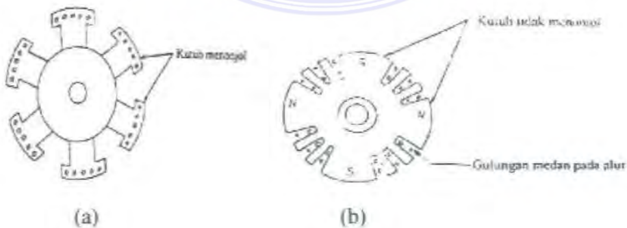
Gambar 4. Konstruksi motor (a).Rotor bentuk menonjol, (b). Rotor bentuk silinder halus
