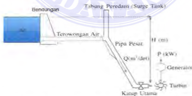
Gambar 3.2. Skema Pembangkit Listrik Tenaga Air
