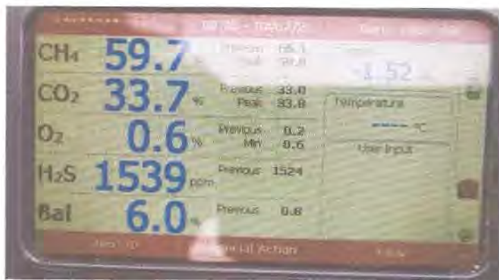
Gambar 3.24 Kandungan Gas Pada Bio-digester Sumber : (Dokumentasi kerja praktik )
