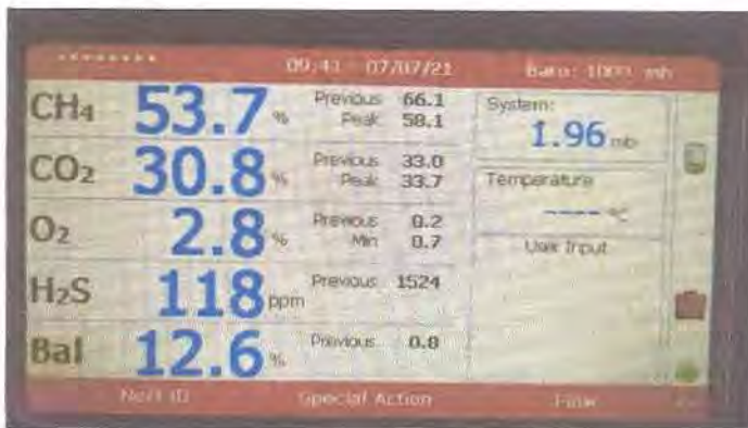
Gambar 3.25 Kandungan Gas Setelah Purifikasi Sumber : (Dokumentasi kerja praktik )
