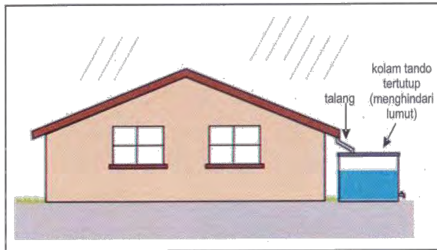
Gambar 2.8 Kolam pengumpul air hujan diatas permukaan tanah dengan penyaring daun, debu dan penutup tangki atau kolam Sumber: Maryono Agus, Buku Memanen Air Hujan , 2020
