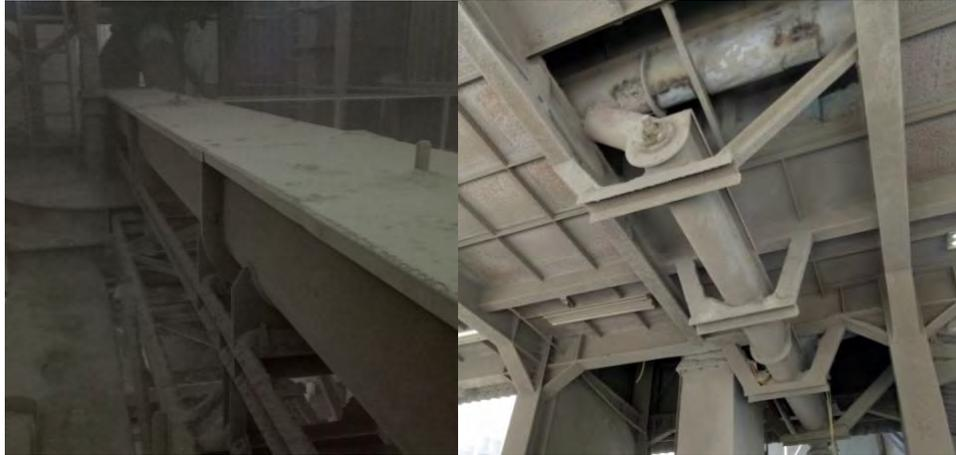
Gambar a) Screw konveyor 22 m
