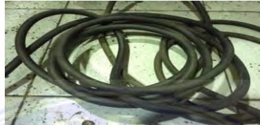
Gambar 2. 10. Kabel Masa dan Kabel Elektroda
