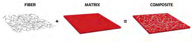
图2.2. 复合材料的构成材料
