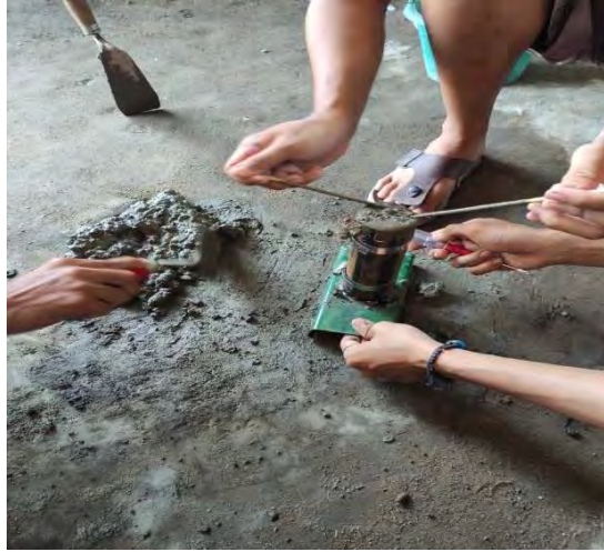
图 3.11. 混凝土骨料浇入模具
