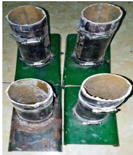
图 3.1. 抗压试验试件模具
