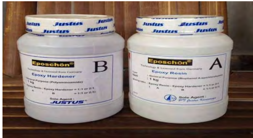
图3.7. 环氧树脂复合材料基体及催化剂（固化剂）
