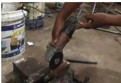
Proses membelah benda kerja menjadi dua bagian dengan gerinda tangan
