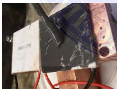
Proses pemberian pasta heatsink pada peltier
