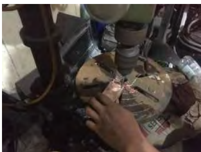
Proses membuat lubang di tiap sudut, yang nantinya sebagai tempat baut pengikat dengan mesin bor duduk
