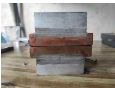
Proses pemasangan heatsink pada peltier
