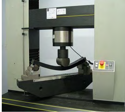
Gambar 2. 15. Pengujian Bengkok ( Bending Test ).
