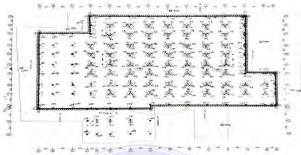
Gambar 3 Layout Titik Pondasi Tiang Pancang
