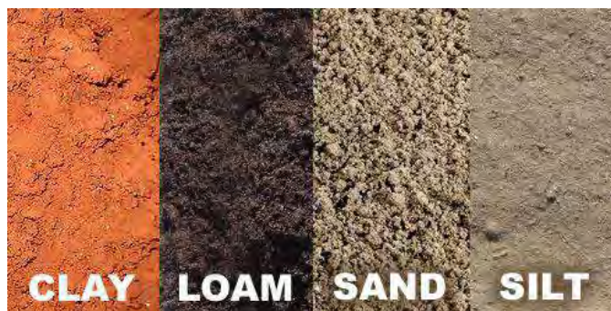
Gambar 2.2 Tekstur Tanah Clay , Loam , Sand , dan Silt
