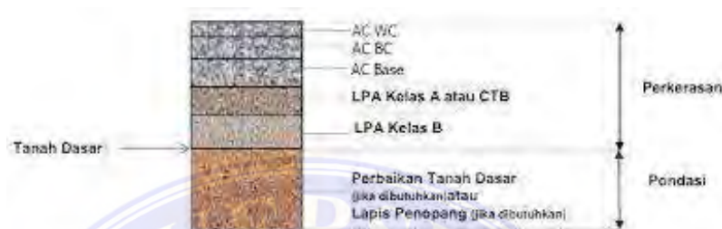
Gambar 2.7 Struktur Perkerasan Lentur pada Tanah Timbunan Sumber: (Kementerian Pekerjaan Umum, 2017)
