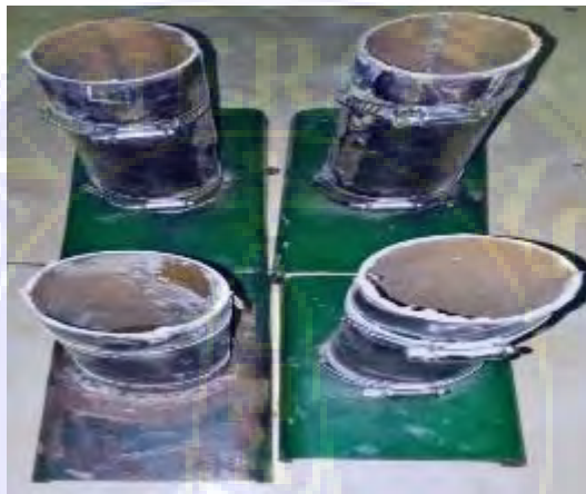
Gambar 3. 1. Cetakan Spesimen Beton Uji Tekan
