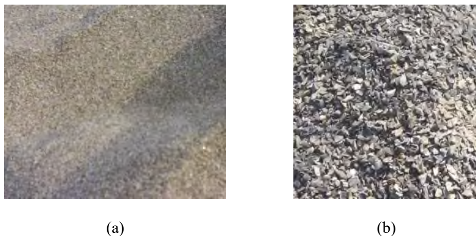
Gambar 3. 8. Agregat beton: (a) pasir, dan (b) kerikil
