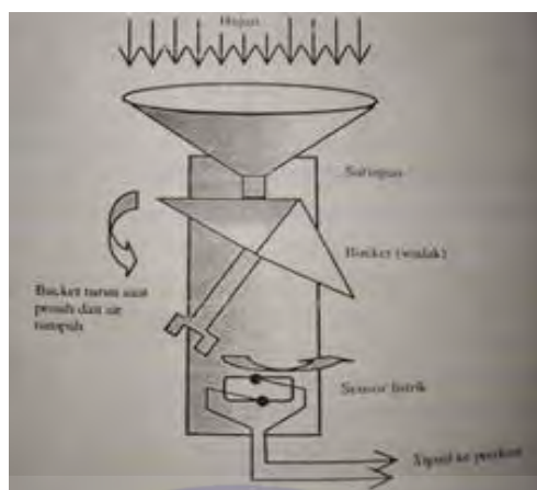
Gambar 2.3 alat penakar hujan otomatis dengan tipping bucket. Sumber : Sistem Drainase Perkotaan, suripin 2004
