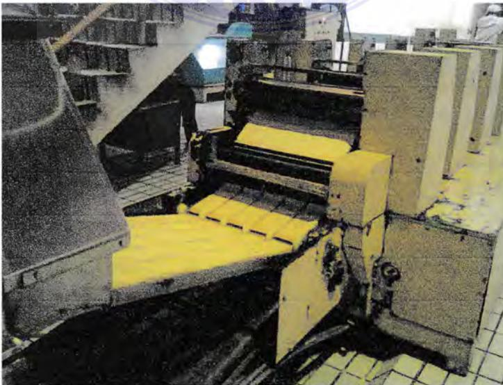
Gambar 1.5. Mesin Slitting
