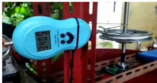
Gambar 3. 14 Mengukur Torsi dengan timbangan tangan digital
