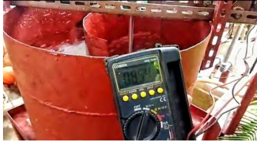
Gambar 3. 12 Mengukur Tegangan dan arus listrik menggunakan multimeter
