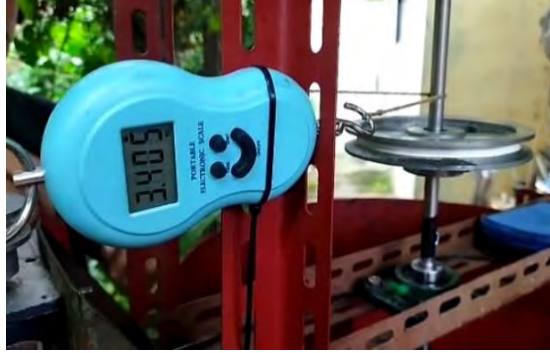
Gambar 3. 16 Mengukur Torsi dengan timbangan tangan digital
