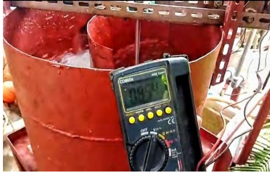
Gambar 3. 13 Mengukur Tegangan listrik menggunakan multitester
