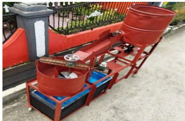
Gambar 3. 2 Turbin whirlpool yang dibuat
