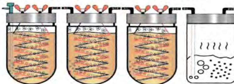
Gambar 2.6.6. Menggunakan tiga tabung elektroliser atau lebih dan satu water trap (multi cell)
