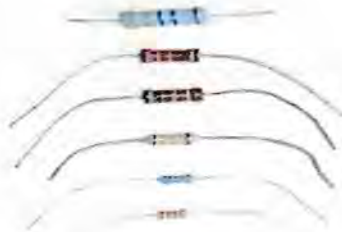
Gambar 2.17 : Bentuk fisik resistor
