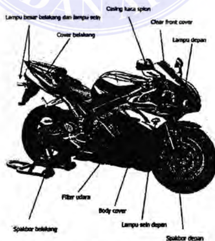
Gambar 2.11. Kendaraan sepeda motor dengan beberapa komponen plastik dari
