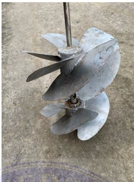
Gambar 3. 2 Turbin Whirlpool dengan sudu bertingkat
