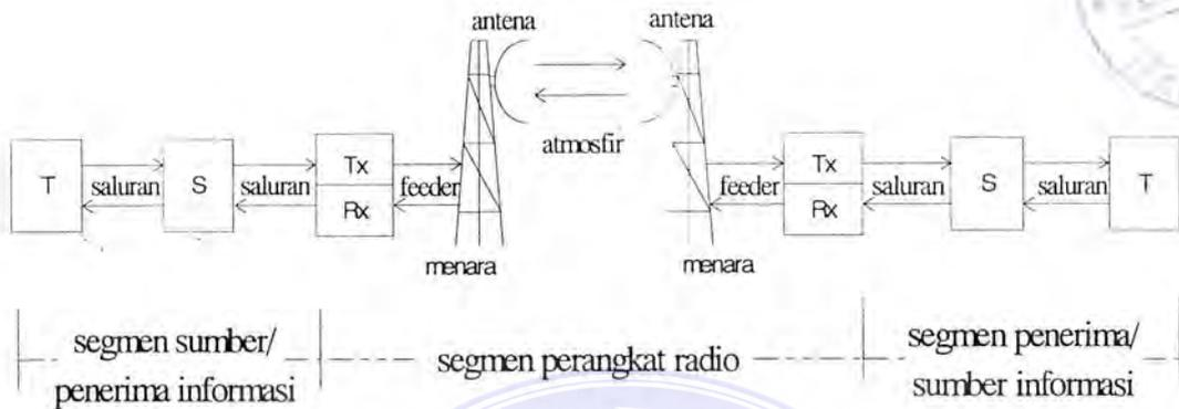
Gambar 2.1 : Blok diagram komunikasi radio
