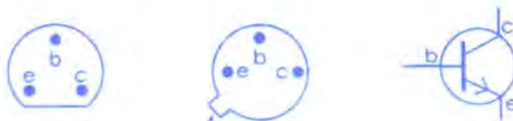
Gambar 2.4 Ilustrasi transistor tampak bawah
