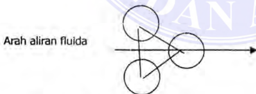
Gambar 3.1. Konfigurasi susunan tube segitiga sama sisi ( 30^\circ )
