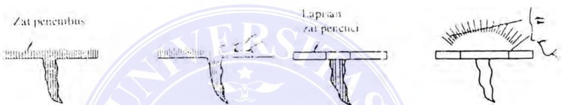
**Gambar: 2.15. Dasar pengujian dengan zat penembus**
