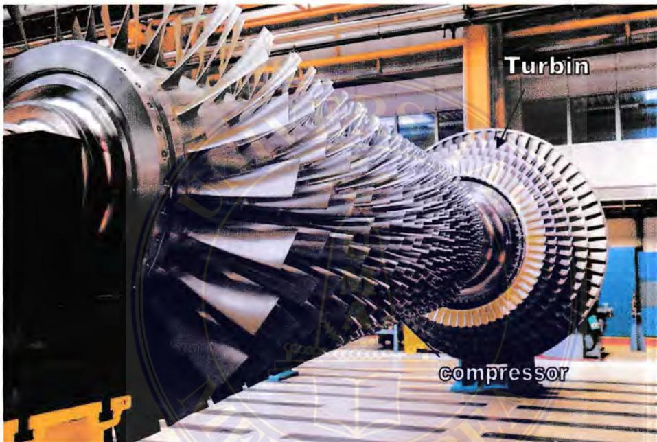
*Gambar 2.10 Turbin dan Compressor spindle*
