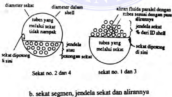
Gambar 2.17 sekat pada sisi shell dan luas saluran melintang
