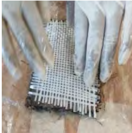
Gambar 3. 12. Pelapisan Susunan Komposisi Laminat
